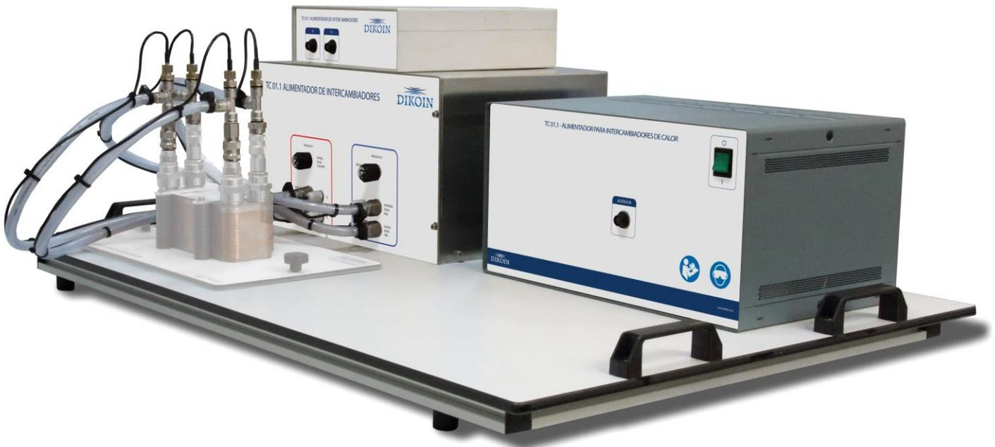
El equipo TC 01.1, es el elemento central del conjunto de intercambio de calor TC 01. Es el módulo que proporciona agua caliente y fría a los intercambiadores de calor, además de medir las temperaturas y caudales en cada elemento.
